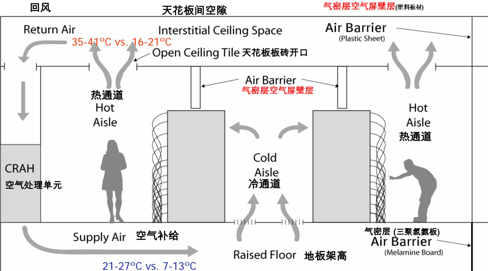
具有冷热气分流功能的区域性制冷系统，可辅助或取代地板制冷系统
