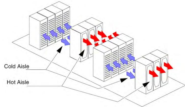
**热通道/冷通道的配置降低了进气口和排气口混合度，提高了能效**
