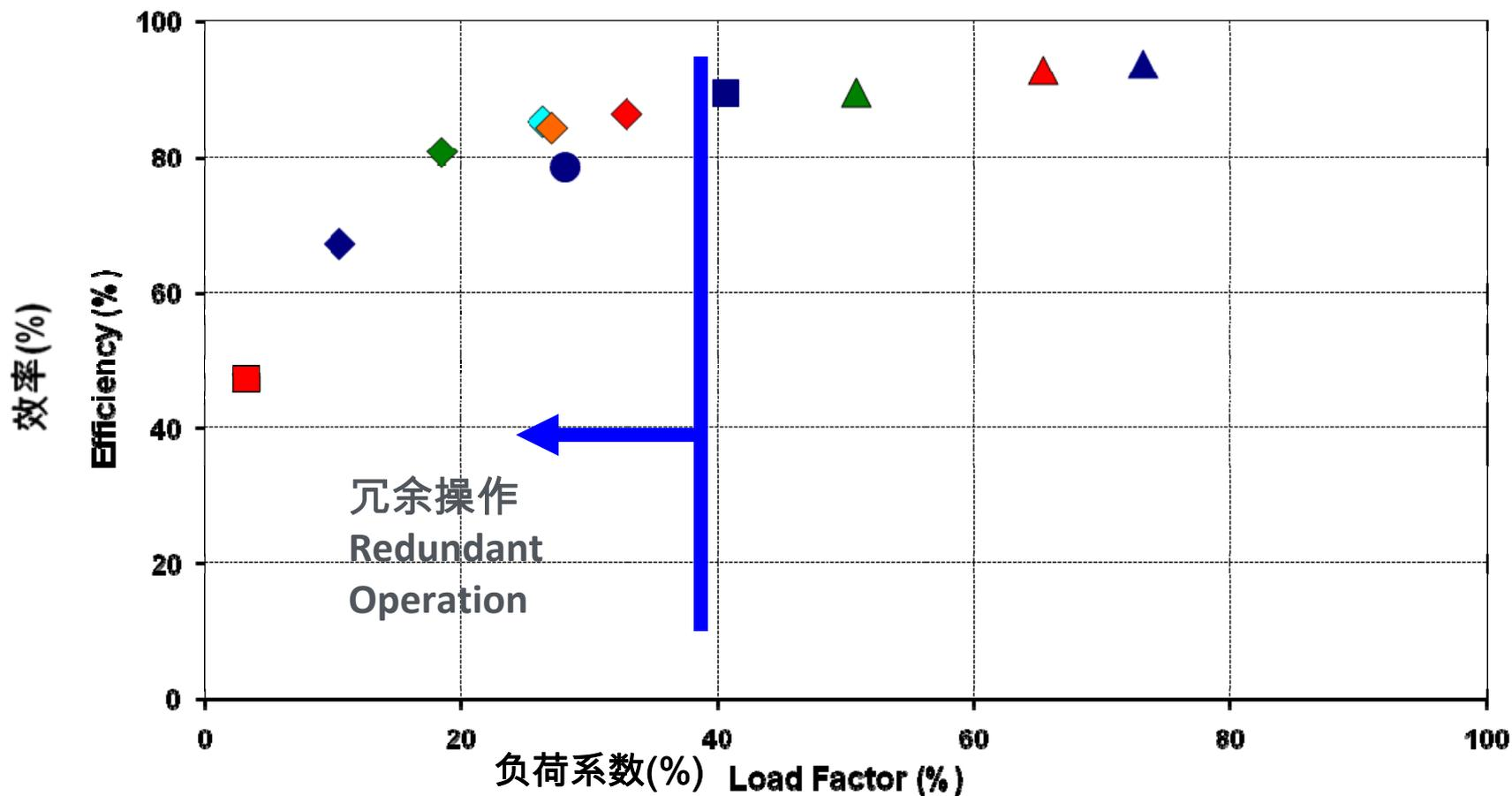
测量到的服务器电源供应效率 (所有的因素)
